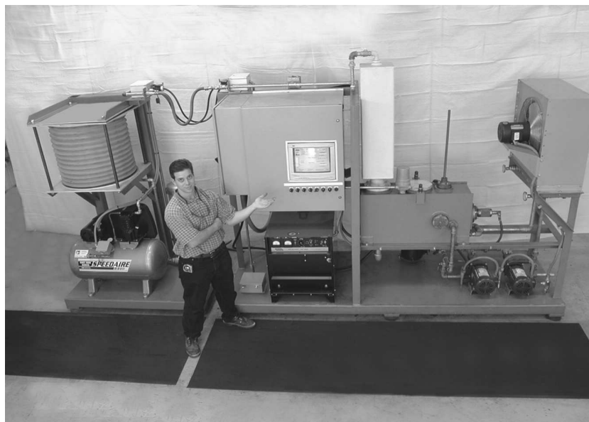
Рис. 7.10: [8] Изображение PlasmaArcFlow TM реактора с источником постоянного тока мощностью 75 кВт, который производит около 1000 куб. футов магнегаза в час, обладающего около 870 BTU на куб. фут, плюс около 500000 BTU тепла в час.
